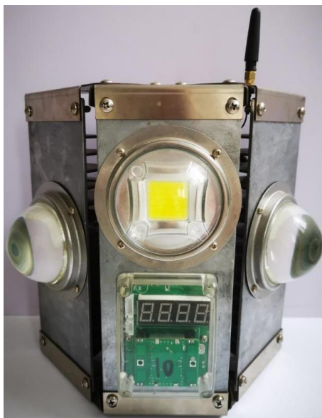
铁路隧道智能灯具系统
