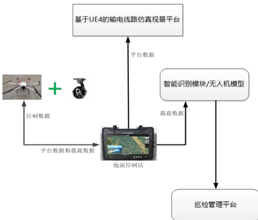
图：输电线路仿真视景平台
