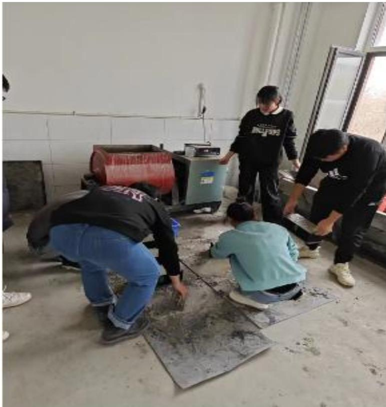
图 2-6. 师生现场做混凝土配合比试验
