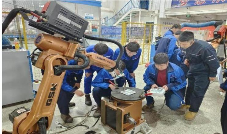
图 9 焊接技术教师宋正雷专业实训课程《多条直线示教再现实训之班名焊接》授课现场
