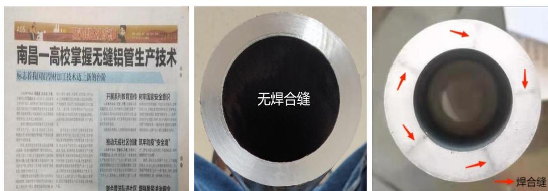
图 30、31、32 世界首创的单动正向挤压生产无缝铝管技术
