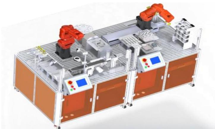
图 5-2 工业机器人一体化创新实训平台（A 型 + B 型）
