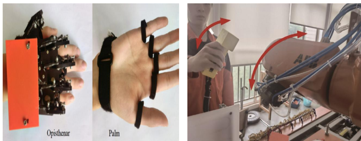
图 3-5 常州刘国钧分院研制的高精度工业机器人人体感控制系统
