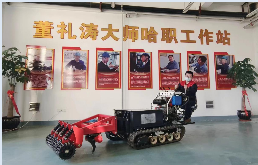
图为一种智能化路面清压实冰雪设备空载试车调试中
