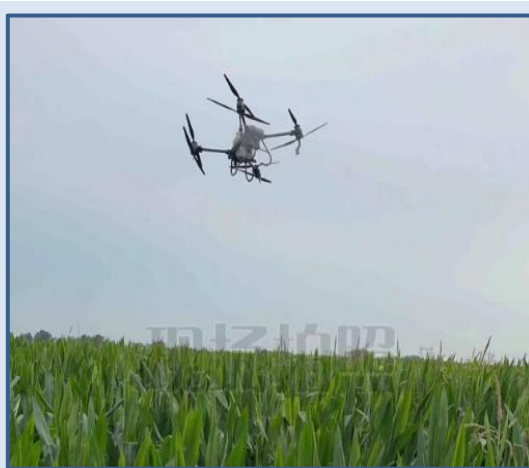
无人机喷洒叶面肥作业
