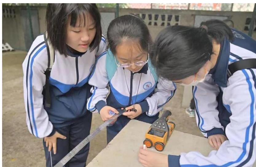
图 3-22 来校参加职业启蒙活动的高中生使用钢筋扫描仪进行钢筋保护层厚度及钢筋间距检测
