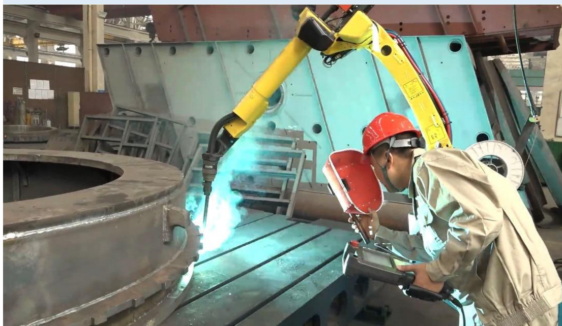
图 6-9 鄂破机自动焊接设备开发项目现场
