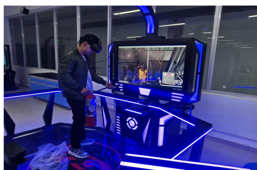
基于 VR 虚拟现实化工安全仿真实训装置
