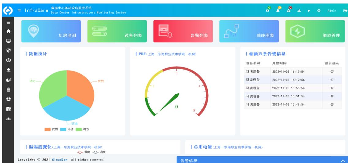
图 22：数据中心基础设施监控系统主界面
