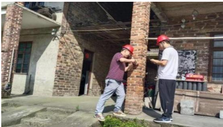
图 4-15 学院党员教师肖毅、王中有现场检测砖柱强度
