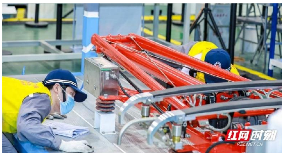
图 1-19 选手刘权东、贺振宇进行受电弓故障排除
