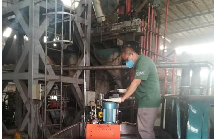
图 34 团队中学生进行翻车机液压健康检测
