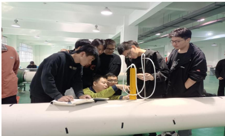
图 3-16 21 级粮食工程技术专业学子在老师指导下进行风机参数测定
