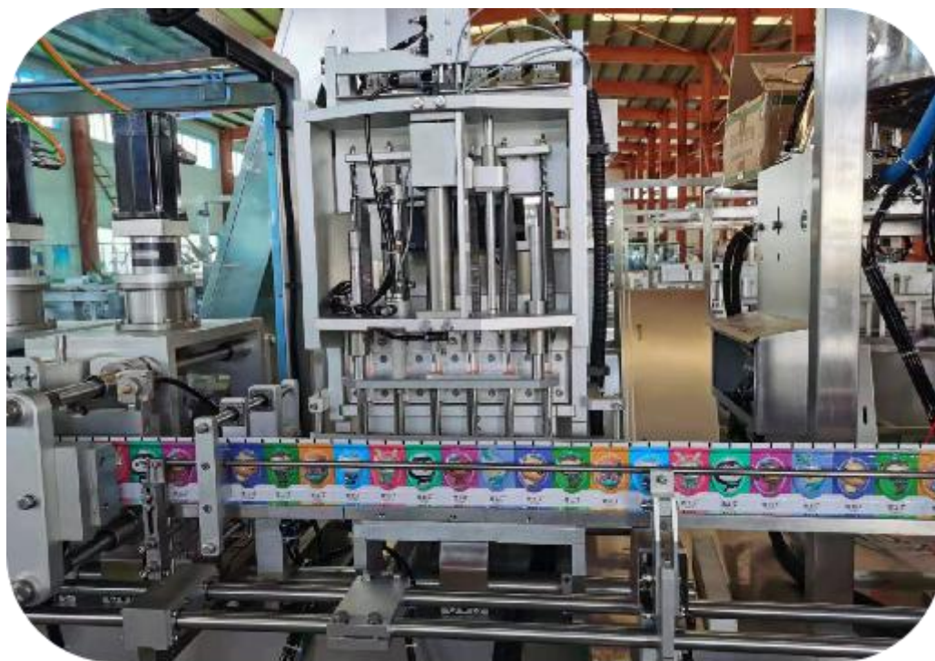
基于机器视觉的奶酪棒柄缺失检测成套装置
