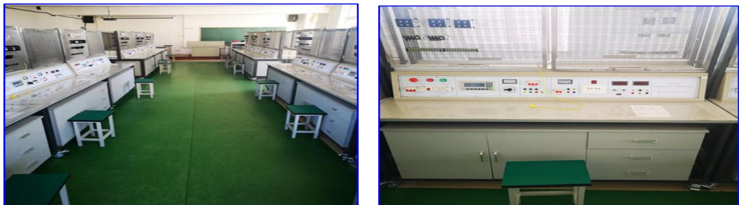
图 8-9 电工实训室、 XK-ETT1 型网孔型维修电工实训考核装置
