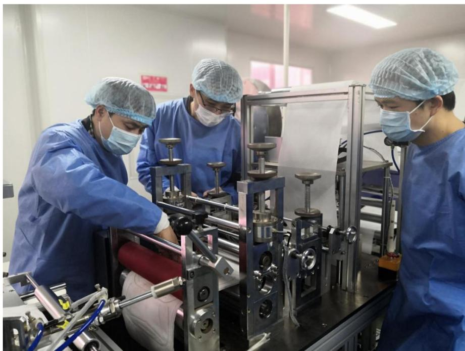
图 5-4 调试 N95 口罩生产线
