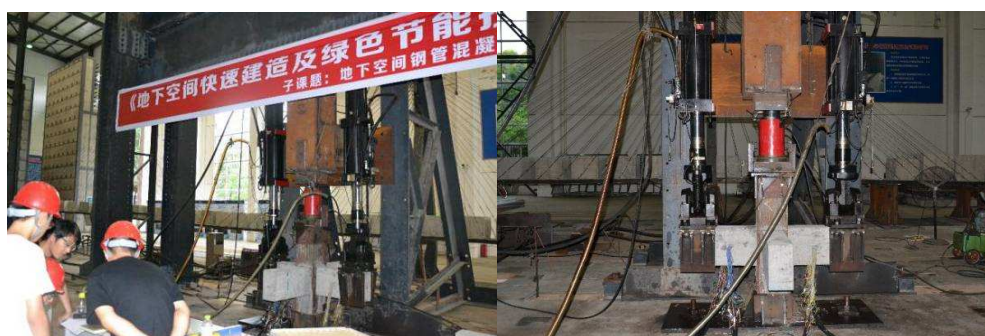
图 14 《地下工程钢管混凝土柱梁体系设计研究》试验现场
