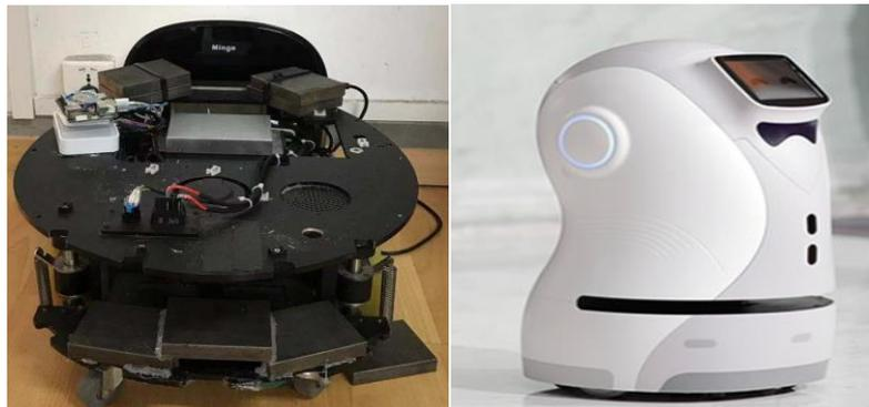
图 6-1 服务机器人通用开发平台及服务机器人 Mingo
