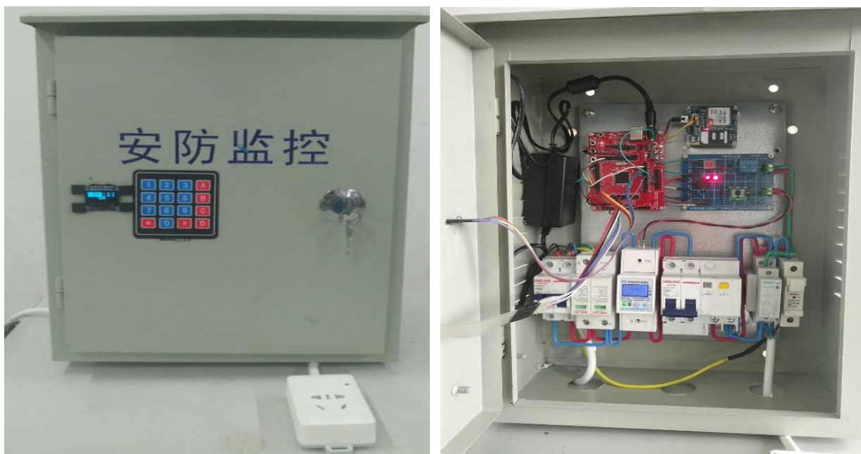
图 6.8 新能源汽车便携式充电枪智能充电控制器
