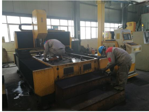
学徒进行钻铣机零件装夹
