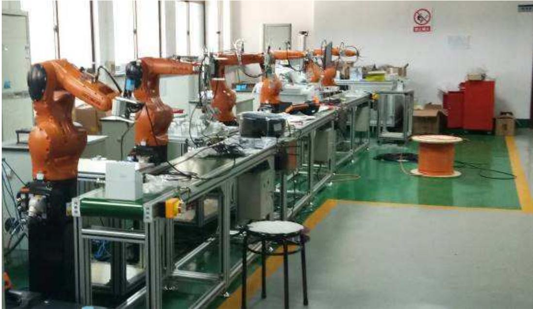
2018年6月，机电工程学院田宝连、寇元金两位专业老师前往湖南科瑞特科技有限公司进行企业学习实习，了解并掌握了 KUKA 工业机器人的电气结构、组成及其功能，通过任务驱动的方式训练对机器人实际操作能力，初步了解并掌握整条流水线的功能和操作流程。通过教师下企业培训，增强了教师技能水平。
