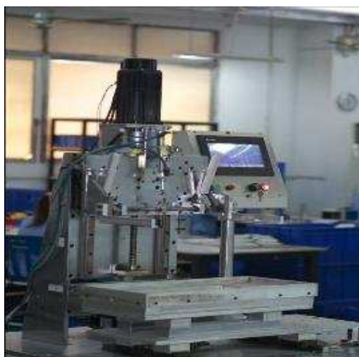
图 5-3 机电工程学院教师研制热敏电阻自动涂胶机 图 5-4 苏鸭远程加工监测系统横向课题合同书
