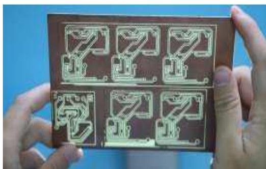
电信专业学生用线路板雕刻机制作的电路板
