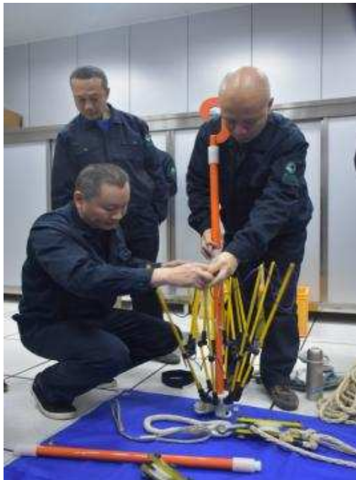
折叠式带电作业安全遮拦结构讲解
