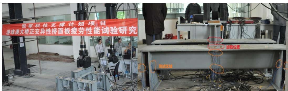
四川建筑职业技术学院承担港珠澳大桥正交异性桥面板疲劳性能试验研究
