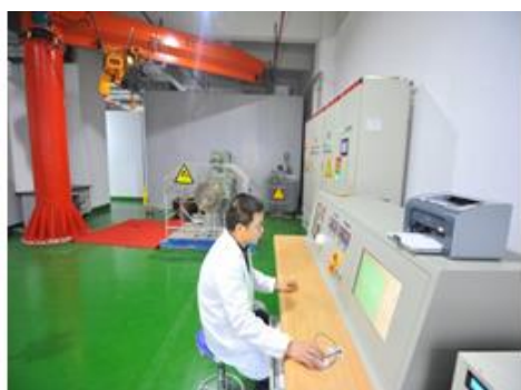
曳引机测试装置
