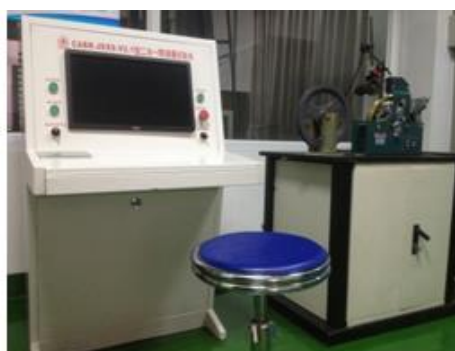
限速器测试装置
