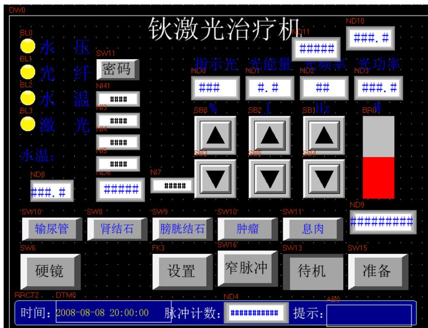
图 4 采用信捷的触摸屏开发的钿激光治疗机界面
