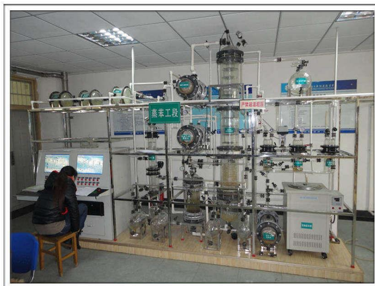
图 12 安全智能化的全玻璃仿真焦炉煤气净化教学工厂
