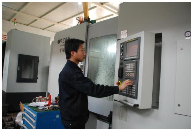
图 2：金后盾投入的设备——四轴卧式加工中心
