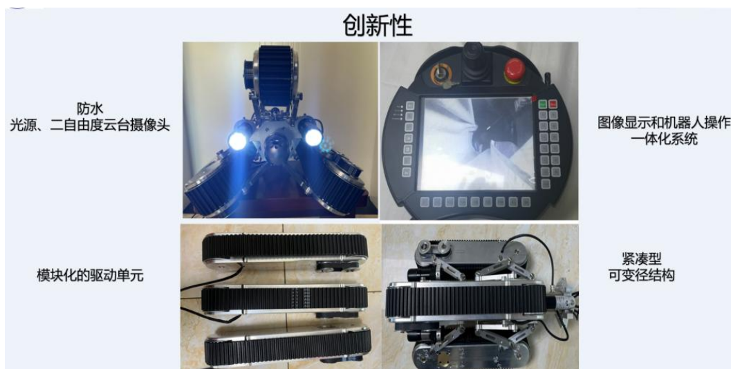
图 3-1 陕西工业职业技术学院开发的管网探测机器人可服务未来智慧城市建设
