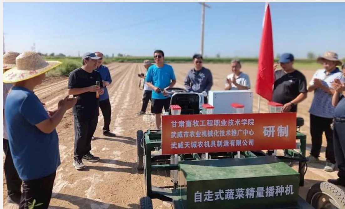
图 19 甘肃畜牧工程职业技术学院自走式电动小粒径蔬菜精量播种机进行现场演示
