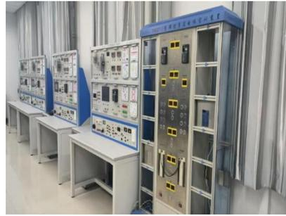
图 84: 群控多层电梯实训装置
