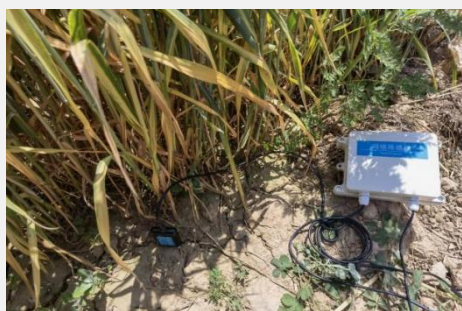
图 1-42 土壤探测器检测土壤质量
