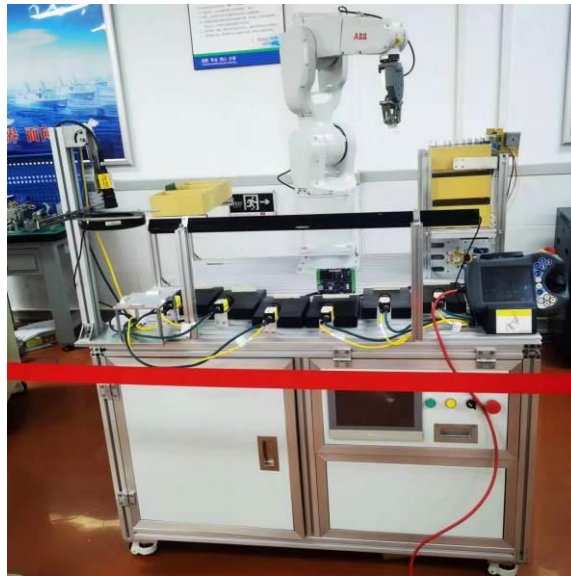
图 4- 1 基于工业机器人技术的物联网控制模块自动测试平台实物图
