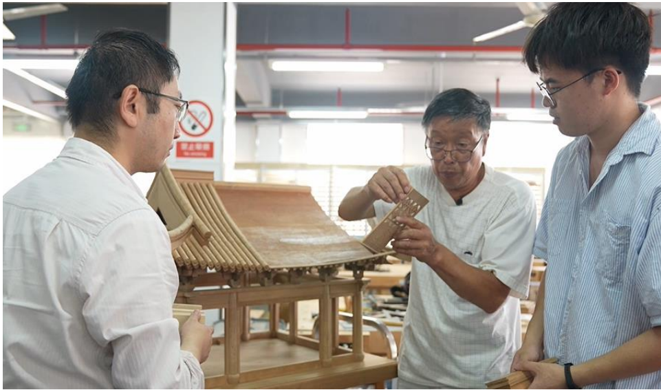
图 2-17 大师指导师生学徒进行仿宋式歇山顶大殿中的木门制作
