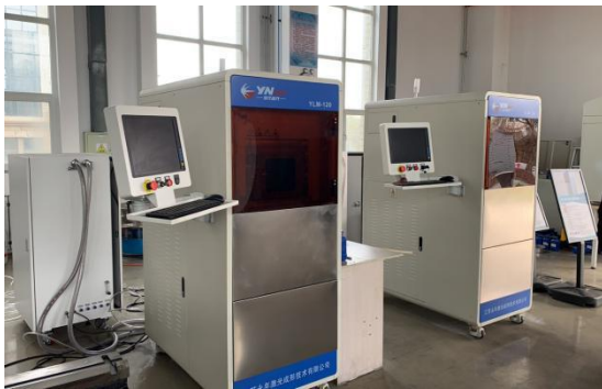
图 2-19 YL120 金属 3D 打印实训室
