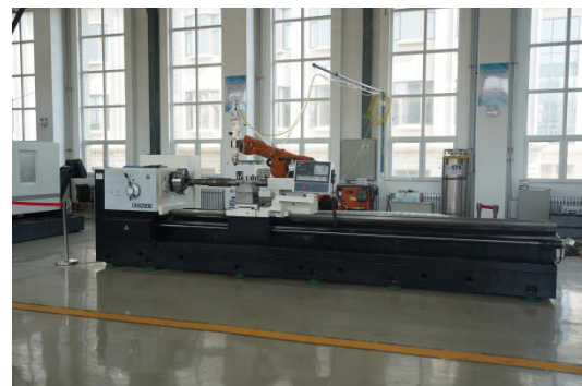
图 2-20 机械手激光熔覆实验实训室
