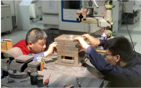
图 2-9 学生进行模具分型面间隙检验图
