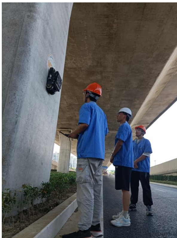
图 46 智能控制学院 2020 级工业机器人专业学生在科研导师指导下调试爬壁机器人（1）
