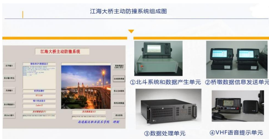
图 58 主动防撞系统的结构组成
