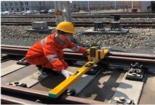
68 图 3-47 轨距测量仪器操作
