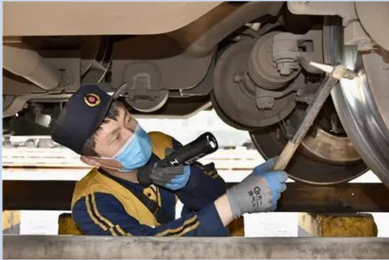
图 5-3 检点锤在现场作业中的应用
