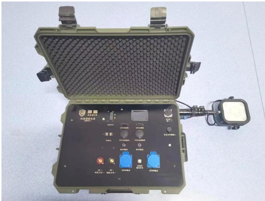
图 7-4 基于 5G 技术户外大容量应急电源样机
