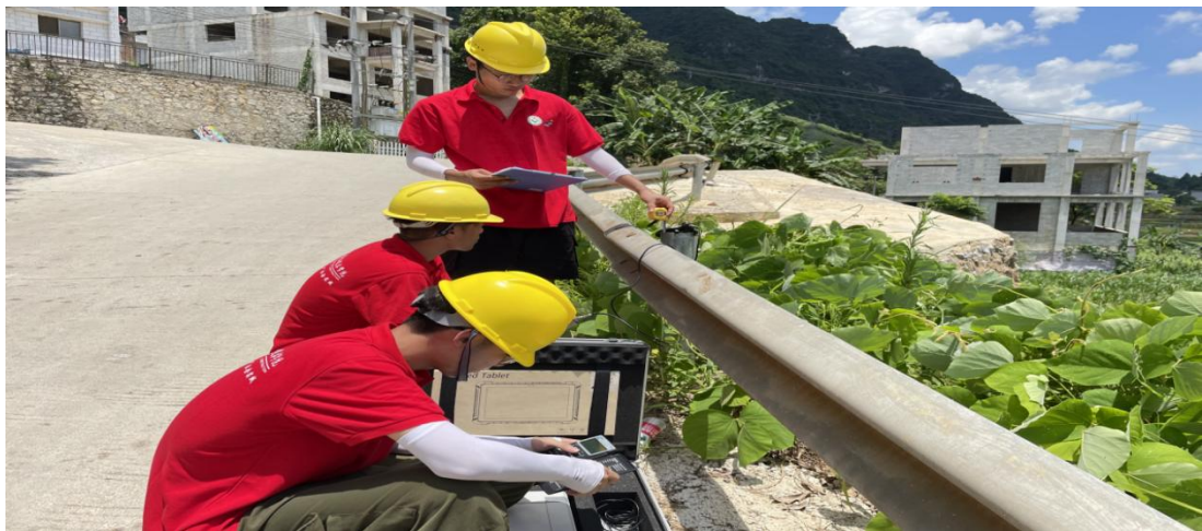
图 5-15 志愿者对钢质护栏埋入深度进行检测
