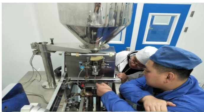
图 18：基地教学实训老师指导学生拆装分装机
