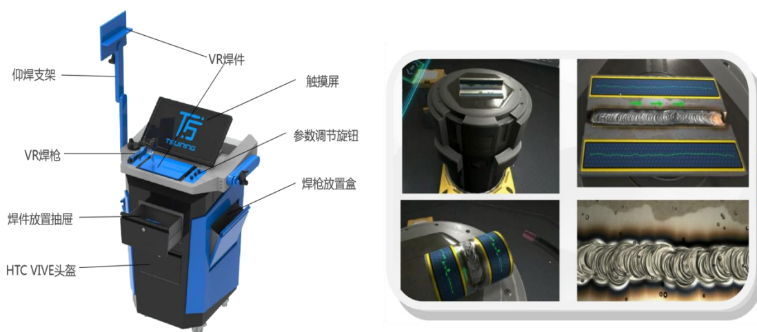
图5 智能焊接沉浸式实训中心
