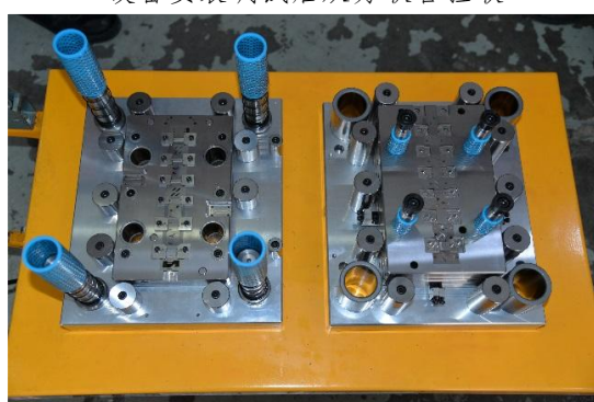
利用该设备开发的手表机芯高速级进模具
