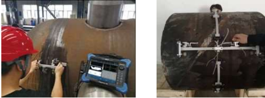
图 13 校企合作共同研发机械扫查装置
