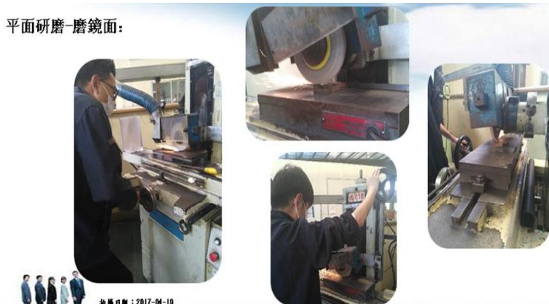
图 29 工学结合实训—平面研磨作业
